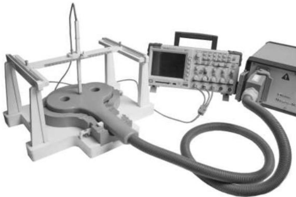
Plataforma de medida de indução de bobinas
